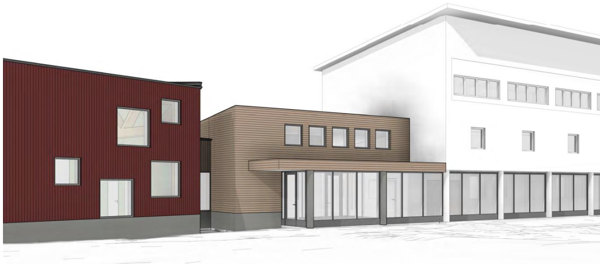
Figur 23 Skiss på utformning av den nya idrottshallen. En huvudentré till den nya idrottshallen och den befintliga idrottshallen skapas i den sammanbindande byggnadskroppen mellan de båda. Vy från nordöst. Illustration: FE Arkitekter
