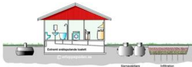
Figur 8.2 Principskiss för avloppsanläggning med sluten tank för WC och infiltration av BDT-vatten
