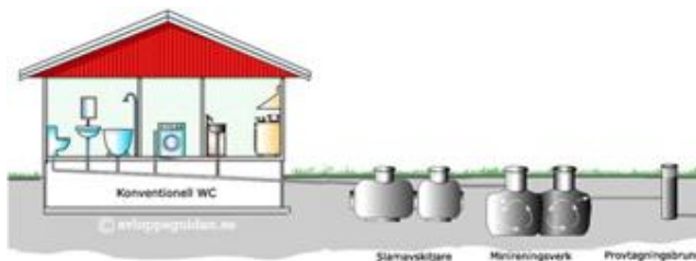
Figur 8.4 Principskiss för avloppsanläggning med minireningsverk
