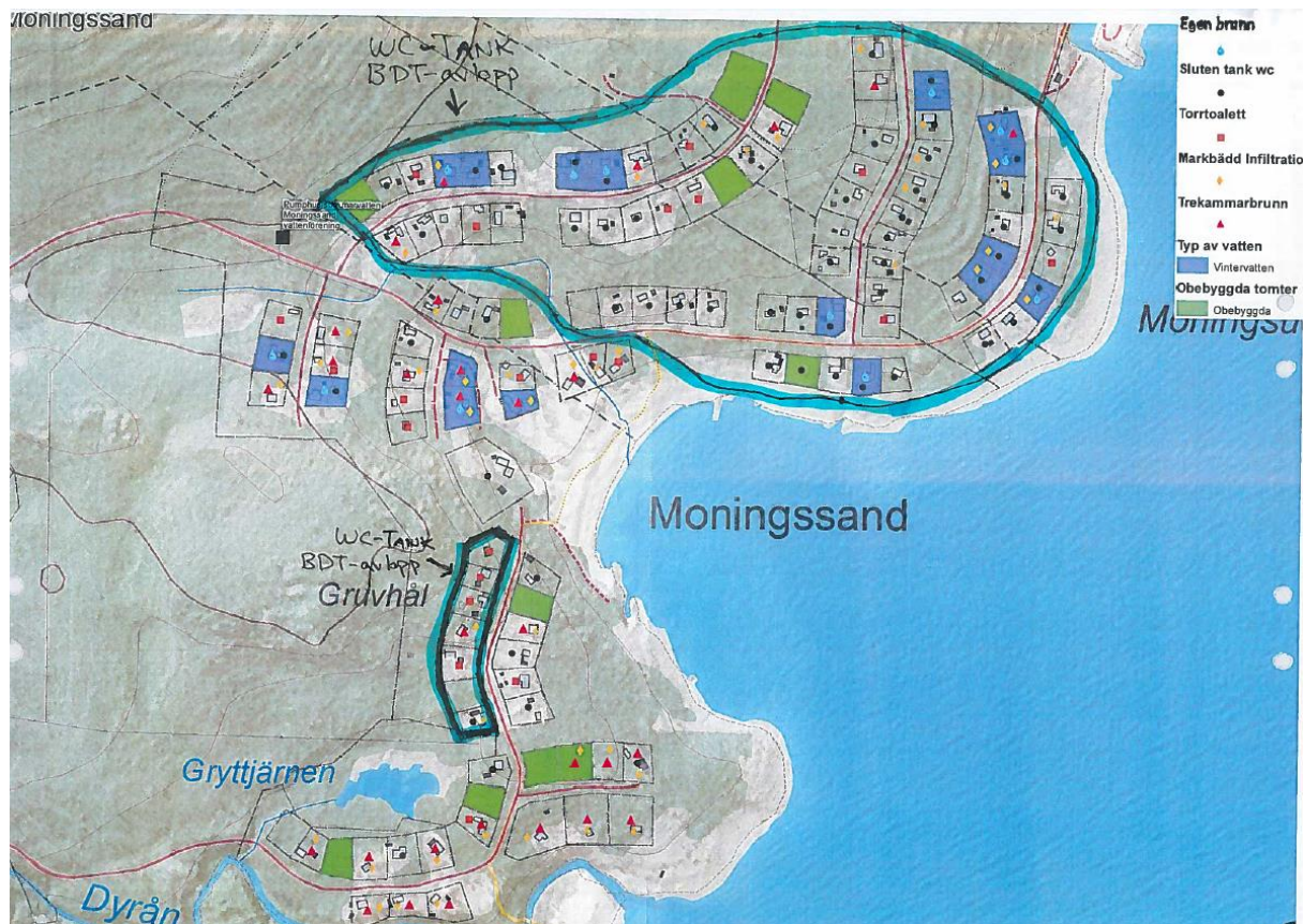
Figur 1 Kartan är framtagen år 2015 i samarbete mellan Plan- och bygghkontoret och Norrhälsinge miljökontor. Kartan beskriver hur de olika fastigheterna löst vatten- och avlopp inom området.
